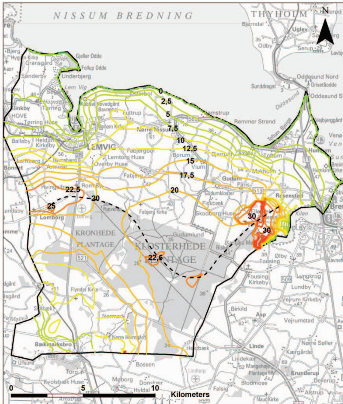
Figur 2-21: Kontureret potentialekort for lag 2 - det øvre magasinlag. Grundvandsskel markeret med stiplede linie.
